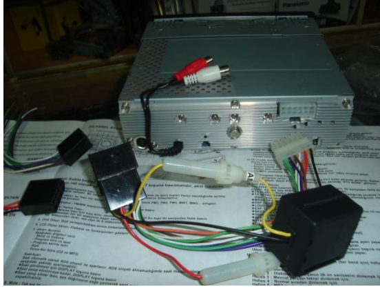
Şekil 2.7: Teyp bağlantı kabloları
