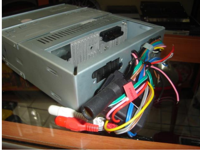
Şekil 2.9: Teyp bağlantı kabloları
